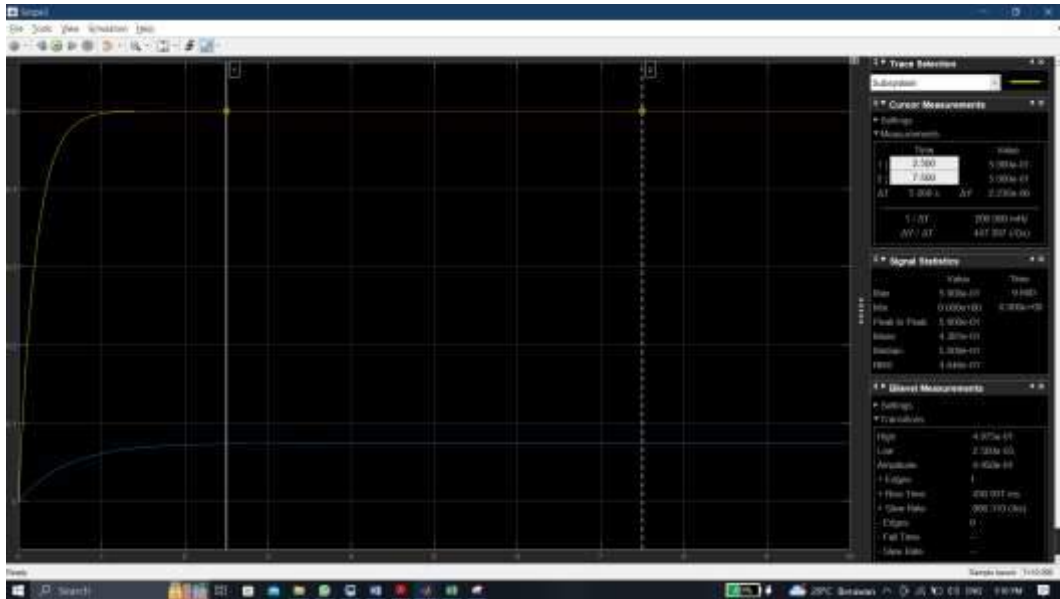
Gambar 10.17 Hasil Perbandingan Respon Motor DC RS PRO 834-7641 dengan Metode LQR dan Tidak
