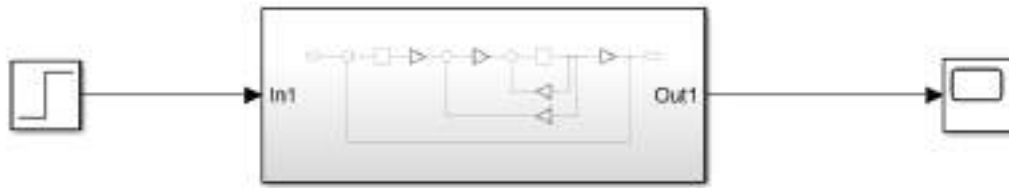
Gambar 11.5 Rangkaian LQR Motor DC RS PRO 454-0883
