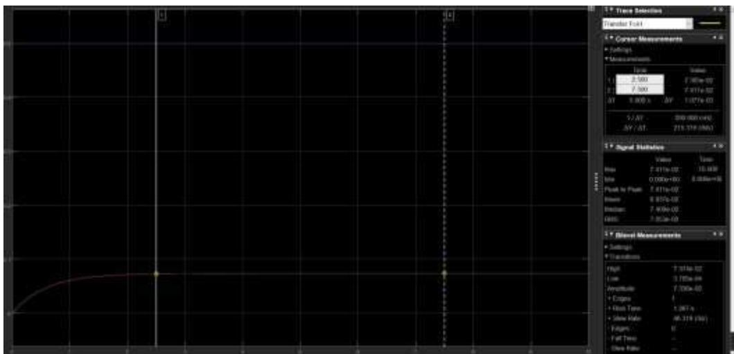
Gambar 5.9 Hasil Respon Motor DC 37-GB500 Orde Satu
