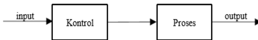
Gambar 2.2 Sistem Kendali Loop Terbuka
