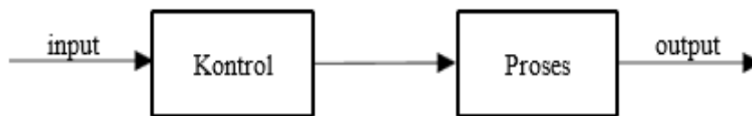
Gambar 7.2 Sistem Kendali Loop Terbuka [9]
