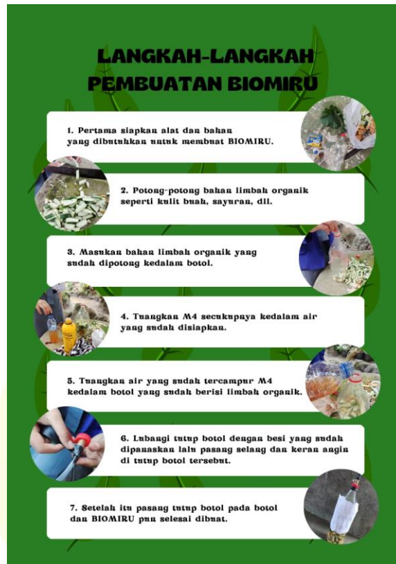
Gambar 9: langkah-langkah pembuatan biogas
