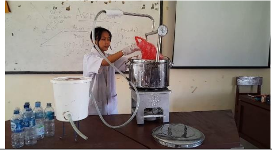
2. Peneliti Memasukan Potongan Plastik LDPE dan PET ke Dalam Tabung Evaporator
