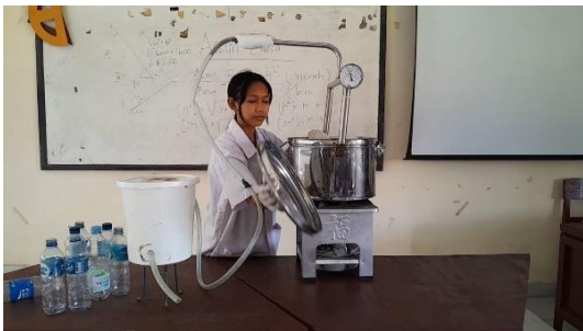
3. Peneliti Mulai Memanskan Alat Hotcoldbox untuk Mencairkan Potongan Plastik
