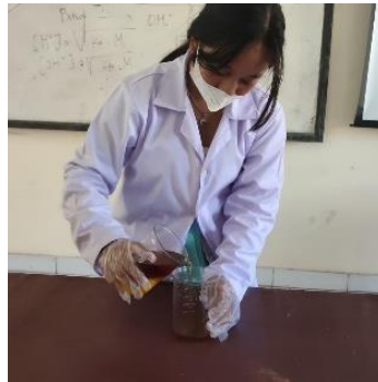
Pemisahan Bioetanol dari endapan sisa NaOH, air, dan gliserol
