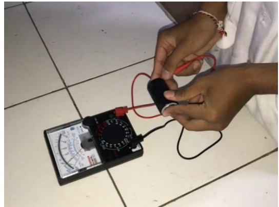
Peneliti Sedang Melakukan Uji Tegangan Pada Biobaterai
