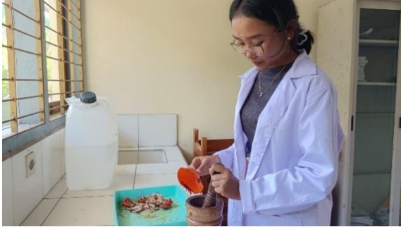
Peneliti Sedang Menghaluskan cangkang kepiting, lalu di oven hingga menghitam
