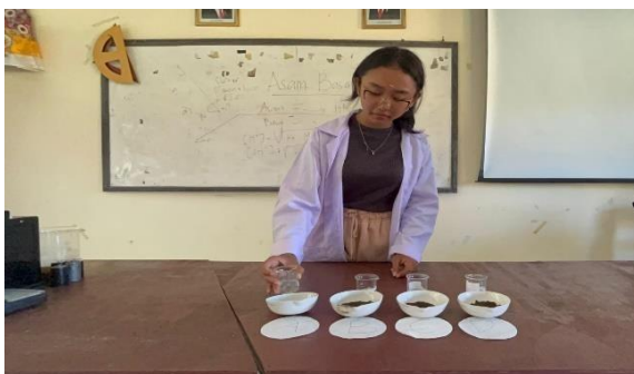
Peneliti Sedang Mencampurkan alrutan asam jawa ke dalam pasta biobaterai yang telah dibuat
