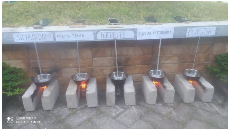
Gambar 4.3 Pengujian pembakaran minyak dengan mendidihkan air
