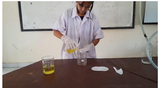
6. Peneliti Melakukan Penyaringan pada Minyak untuk Memisahkannya dari Air yang Kemungkinan Ada Pada Minyak Tersebut
