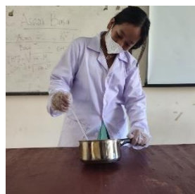
Setelah suhu minyak mencapai 60°C, angkat minyak dari kompor sambil terus diaduk
