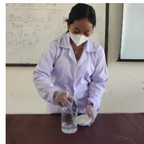
Mencampurkan 4,5gr NaOH ke dalam campuran Metanol kemudian diaduk sekitar 30 menit
