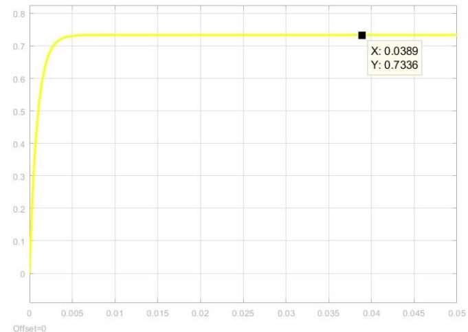
Grafik yang ditampilkan merupakan hasil simulasi sistem orde satu dalam kondisi *closed-loop* atau sistem tertutup. Terlihat bahwa respons sistem terhadap masukan langsung meningkat secara tajam dari nol dan dengan cepat mencapai kondisi tunak pada nilai sekitar 0.74. Bentuk kurva ini halus, tanpa adanya osilasi atau lonjakan (*overshoot*), yang merupakan ciri khas dari sistem orde satu yang stabil dan terkontrol dengan baik dalam kondisi tertutup.
