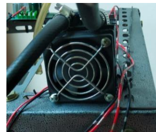
Gambar 9. Pelepasan Panas BBM Oleh Radiator
