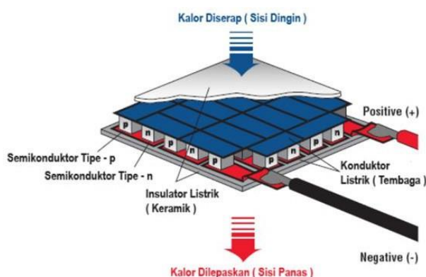
Gambar 1. Komponen TEC Atau Peltier [13]
